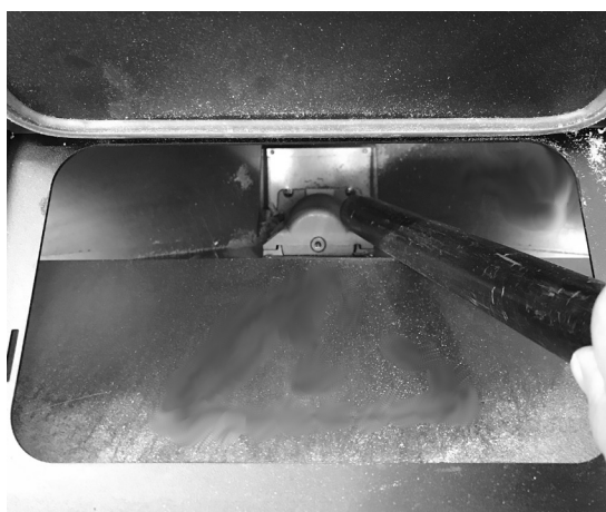
Fig. 35 - Limpieza depósito
