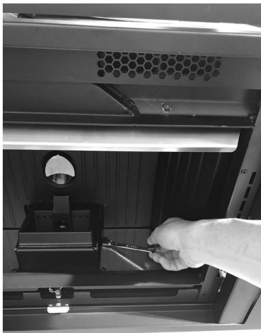
Fig. 36 - Extracción de los pisos
