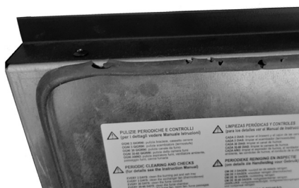
Fig. 23 - Junta deteriorada
